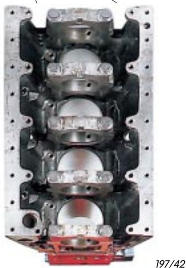
La lamiera di protezione permette l'irrigidimento del blocco cilindri inferiore e il contenimento del flusso di olio.
